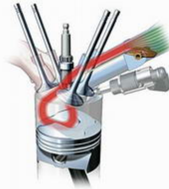
Schichtladebetrieb Stratified charge operation
