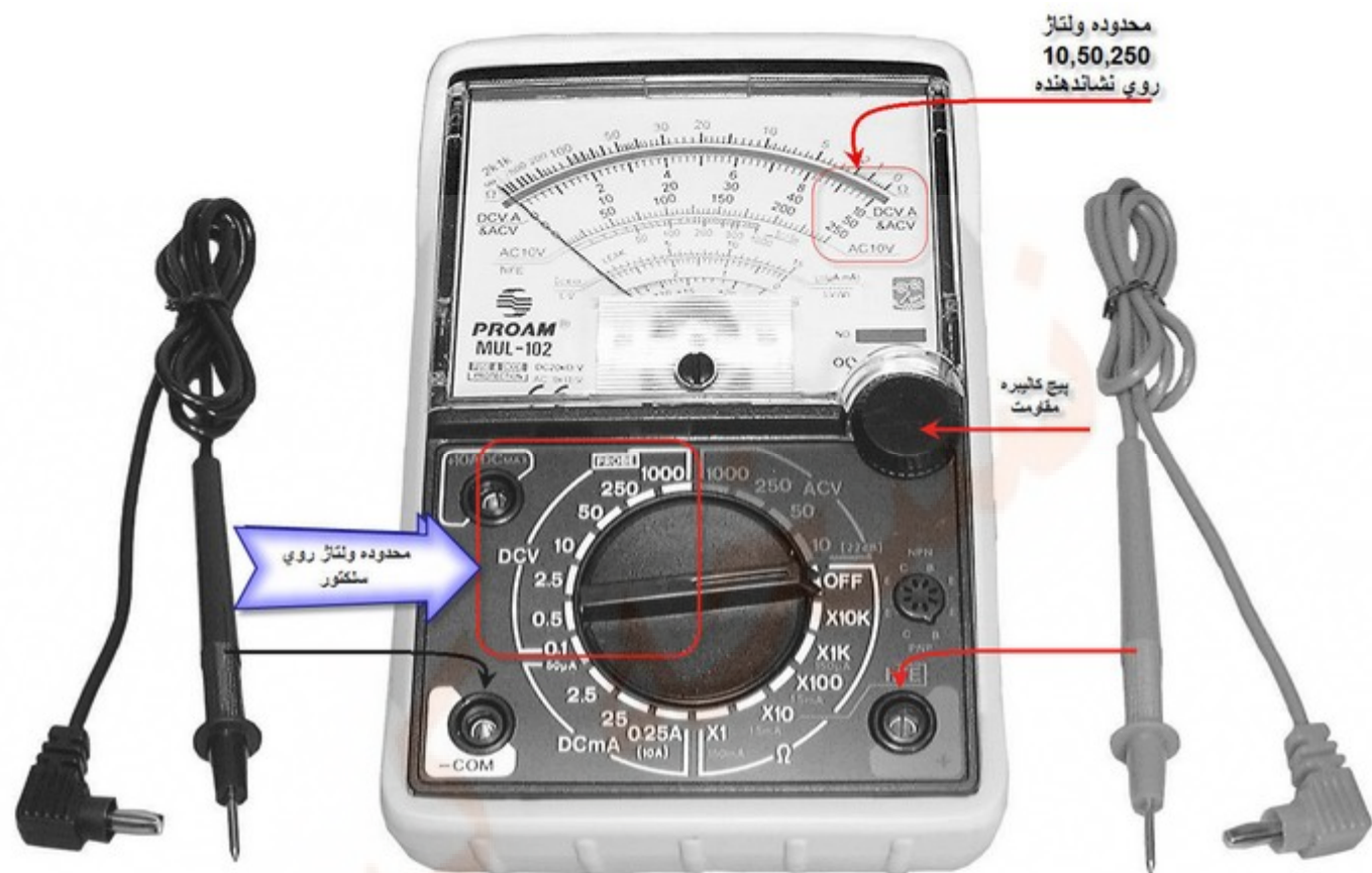
شکل ۱۲ - محدوده ولتاژ روی سلکتور و محدوده ولتاژ روی صفحه نشان دهنده
